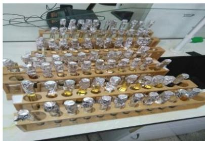
*Figure II.6 : Les séries de 11 tubes à essai pour chaque échantillon laissées à 25 °C pendant 3 jours.*
