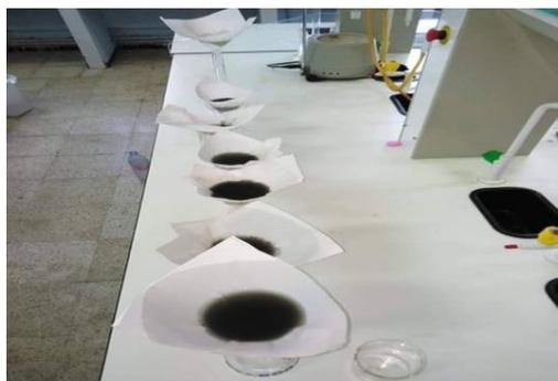
*Figure II.10: Filtration de l'eau usée d'Oued D'hous.*
