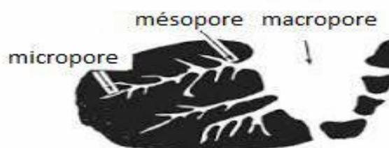
**Figure I. 4 :** Représentation schématique de la structure poreuse du charbon actif [36].
