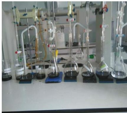
*Figure II.8 : Dosage d'iode par le thiosulfate*
