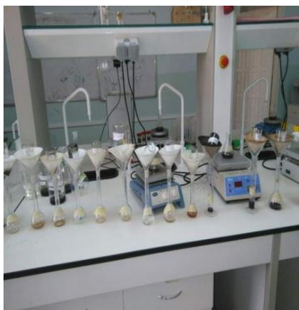
*Figure II.7 : Filtration des suspensions.*
