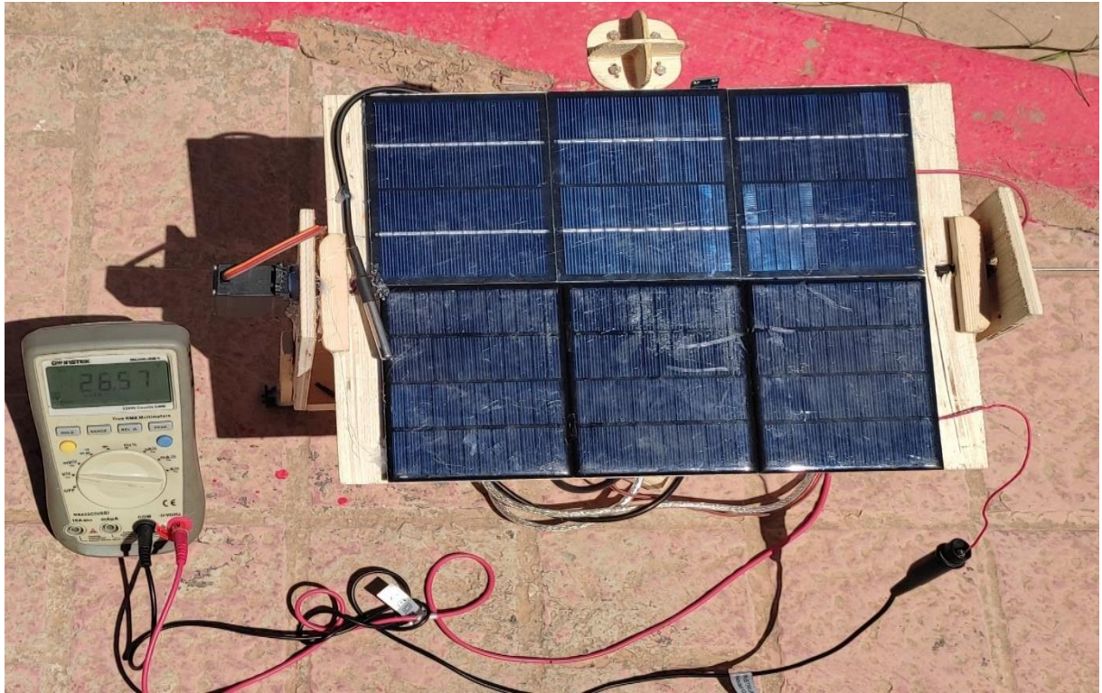
Figure IV.2 : Mesure de Tension circuit ouvert de panneau réalisé.
