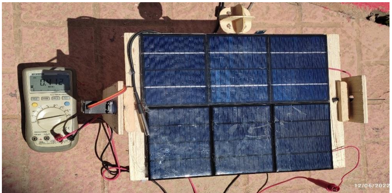
Figure IV.1 : Mesure de Courant de court-circuit de panneau réalisé.
