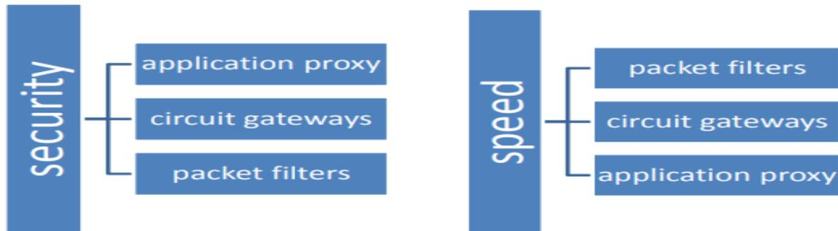
**Figure II.14 :** Comparaison des technologies des firewalls en termes de sécurité et de rapidité.
