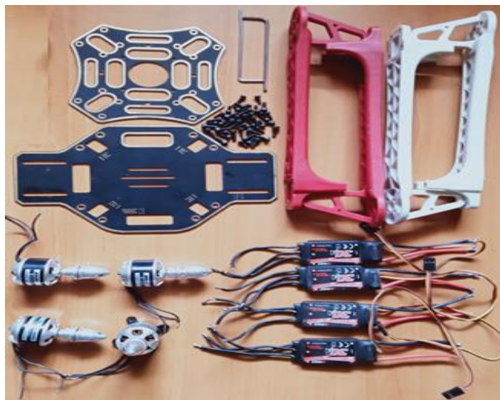
Fig. 3.1 : Les pièces du châssis fantôme F 450, les moteurs et les ESC
