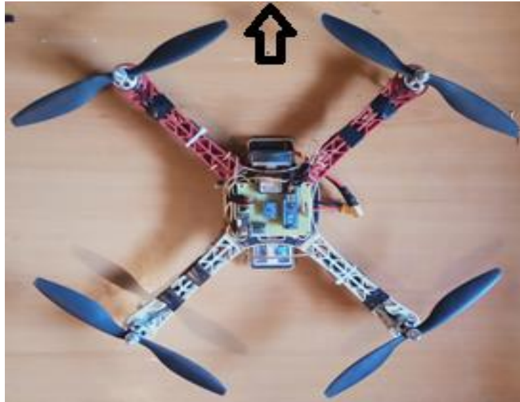
Fig. 3.6 : Châssis du drone et contrôleur de vol
