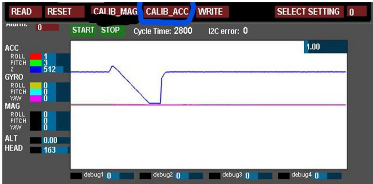
Fig. 3.18 : Calibrage du MPU 6050
