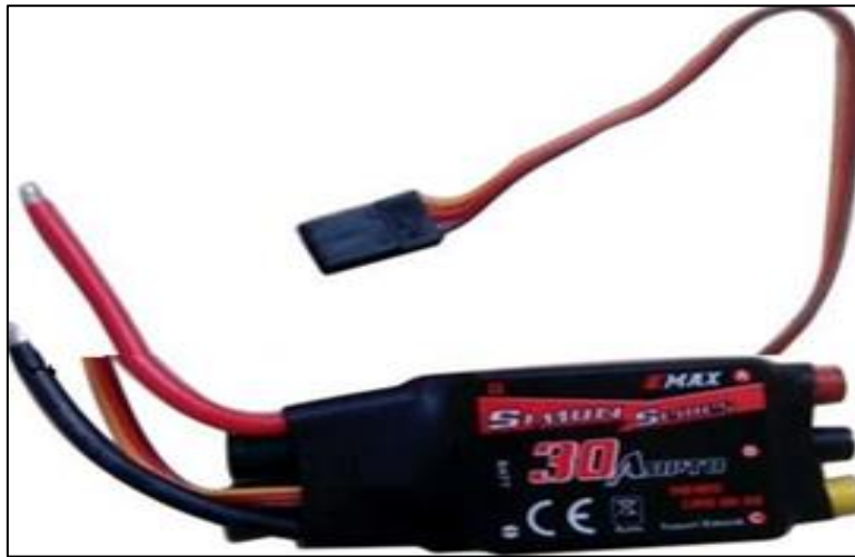
Fig. 2.9 : Contrôleur de vitesse ESC 30A 3-4S EMAX
