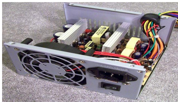
Figure II. 18 .Alimentation électrique 12V de PC
