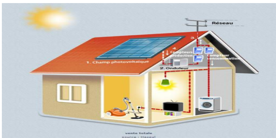
Figure 1.12 : Système photovoltaïque connecté au réseau [19]
