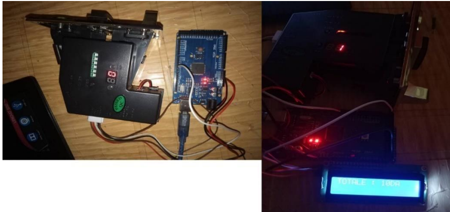
Figure III. 7 : Test et configuration de monnayeur.
