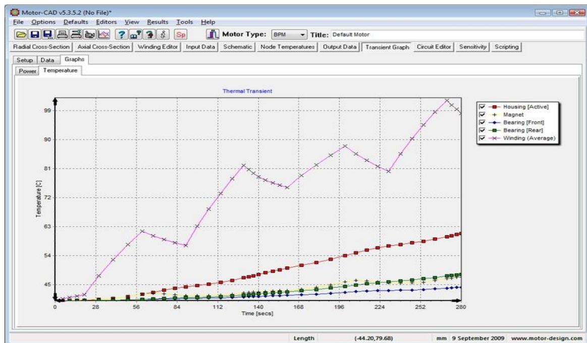
Figure III.2 : Résultats thermiques obtenus par Motor-CAD (régime transitoire) [21].
