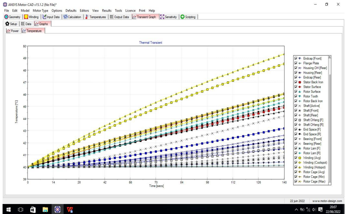
Figure III.23 : Graphe de température de chaque composant constituant le moteur.
