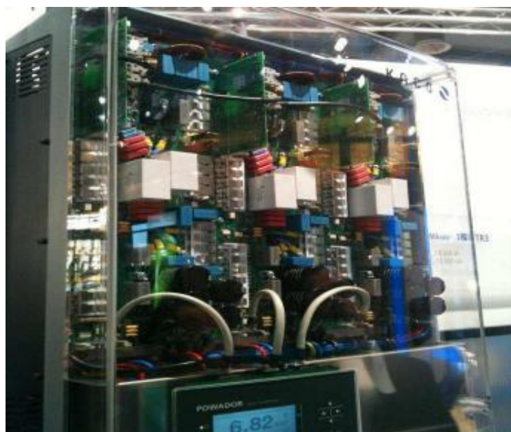
Figure 26 : Vue intérieure d'un onduleur
