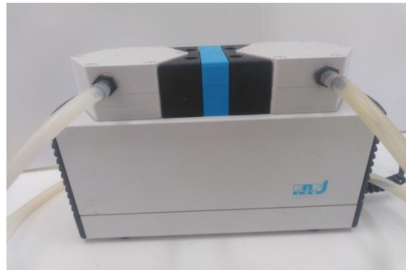
Figure II. 4 : pompe à volume faible(LVS)
