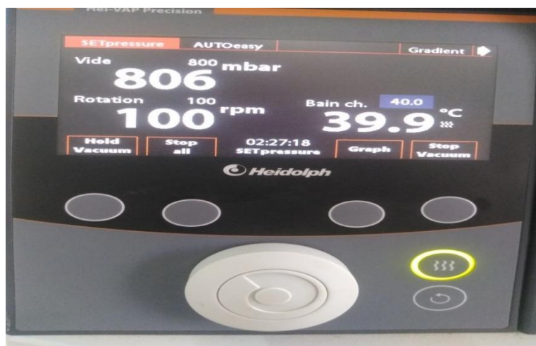
Figure II.16: Paramètres expérimentaux de vide, rotation et de température dans l'évaporateur rotatif.
