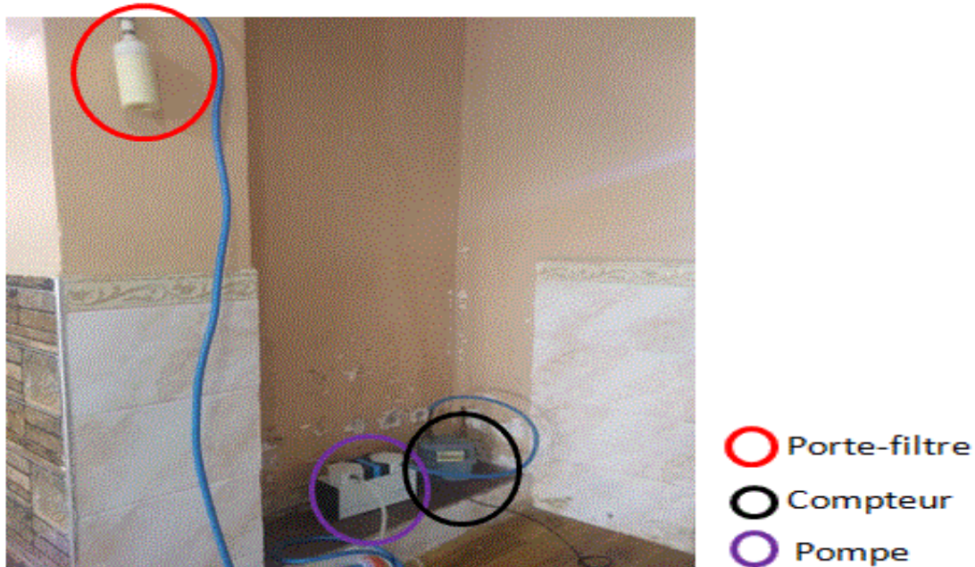
Figure II. 1 : montage de prélèvement des particules.
