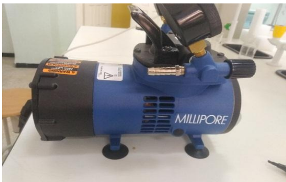
Figure II. 3 : pompe à volume moyen(MVS)
