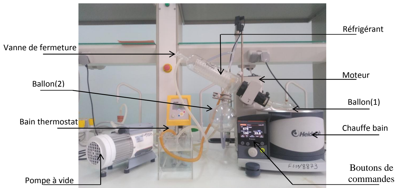
Figure II.15 : Dispositif de l'évaporation rotative pour la concentration.
