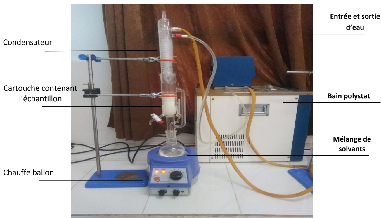
Figure II.14: L'appareillage d'extraction au Soxhlet.
