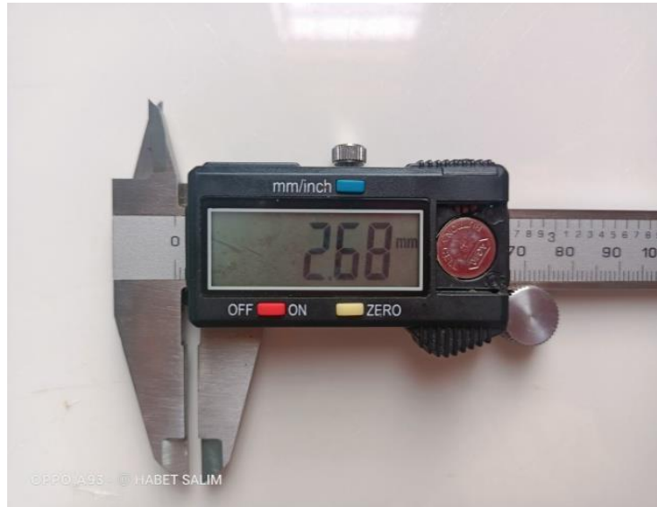
Figure 9: Mesure du diamètre des billes à l'aide d'un pied à coulisse.
