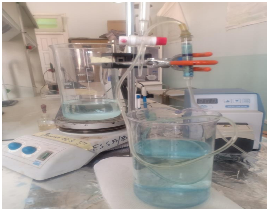
Figure 12: photo du montage de l'adsorption par colonne à lit fixe
