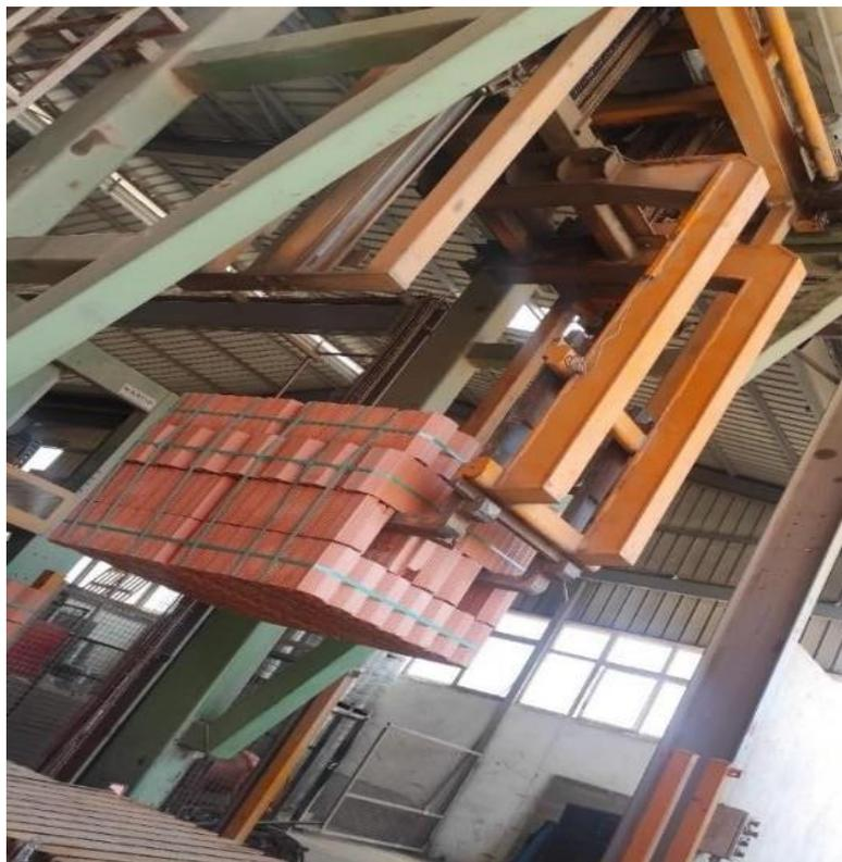
**Figure II.1: Robot industriel à 3axe.**
