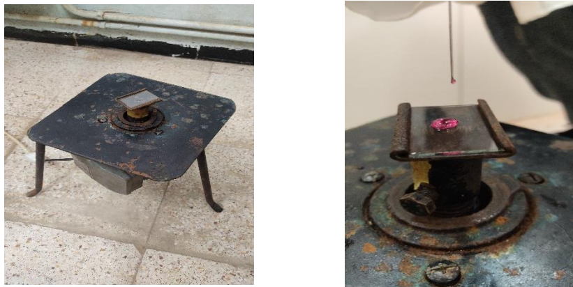
Figure 2. 2: Représente dépôt de la solution sur le substrat
