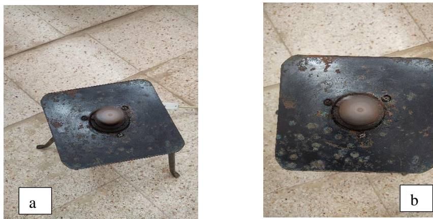
Figure 2. 3 : Représente une rotation : (a) Accélérée du substrat (Spin –up), (b) vitesse constante du substrat (Spin- Off)
