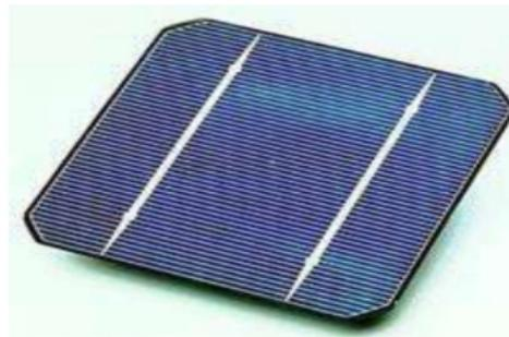
*Figure II- 13:Cellules solaires monocristallines [24]*
