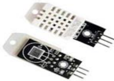
Figure 3.5 : Capteur de température et humidité DHT22. [30]
