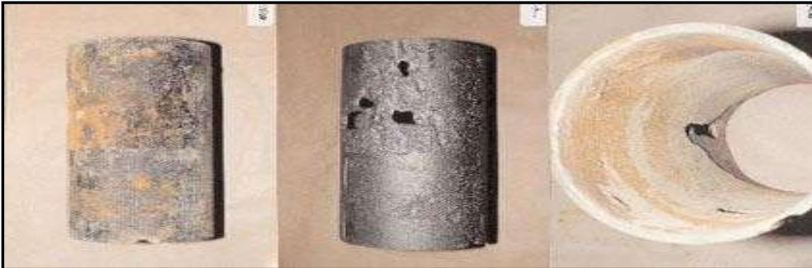
Figure IV-1: Corrosion des conduites en fonte ductile.
