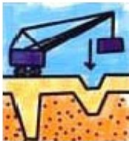
Figure 20 : Principe de réalisation des plots ballastés (Document de Ménard)
