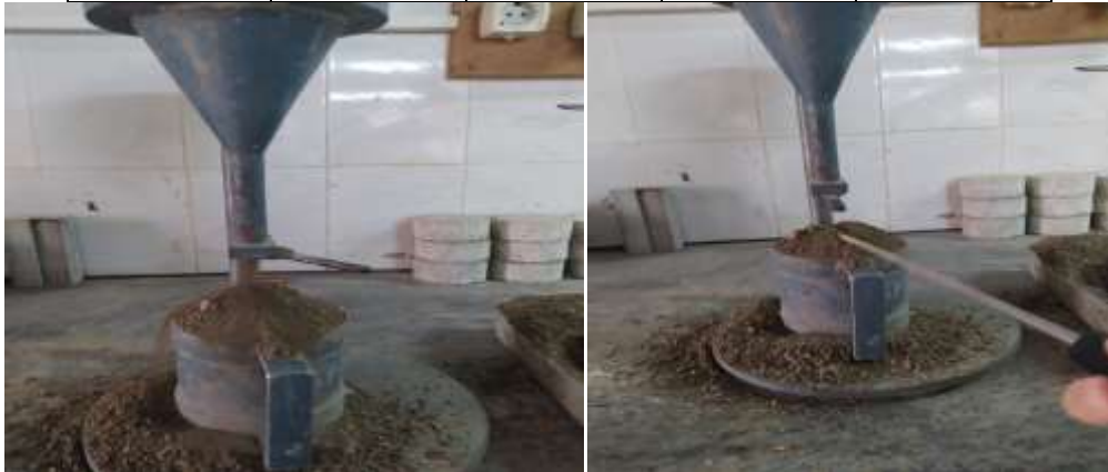
Figure 25. Essai de mesure de la masse volumique apparente par l'entonnoir
