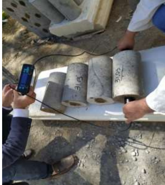
Figure 3. Essai transparent sur une éprouvette à l'aide de l'appareil à ultrasons
