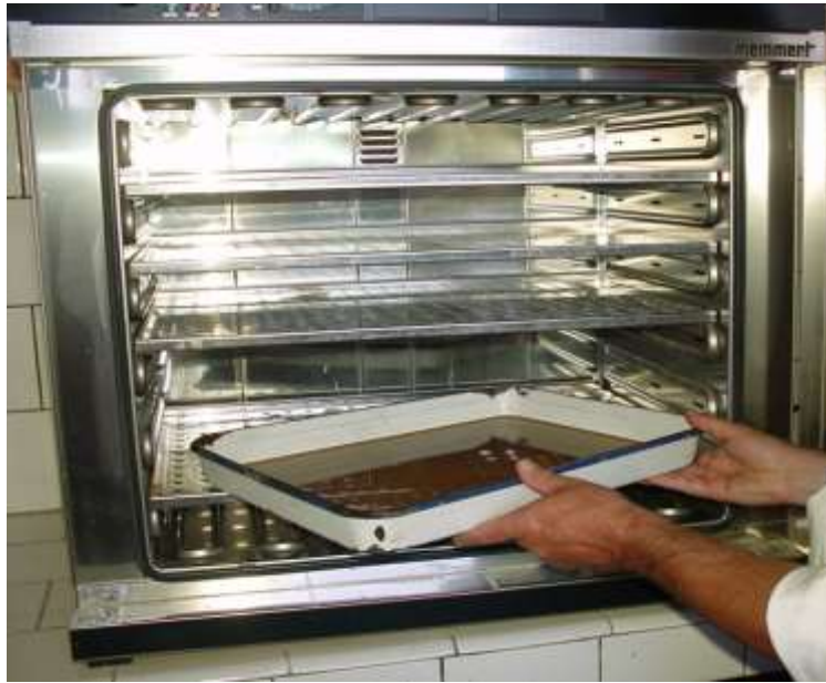
Figure 12. Mise de granulats dans l'étuve
