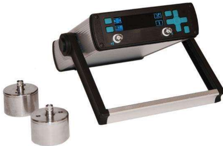
Figure 2. Appareil d'ultrason (punditlab) [16]
