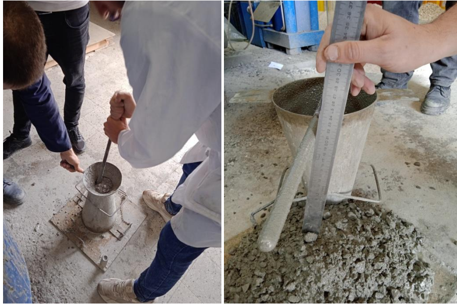
Figure 45: Des photos de l'essai d'affaissement.
