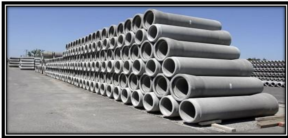
Figure I. 9: Conduites en béton non armé.
