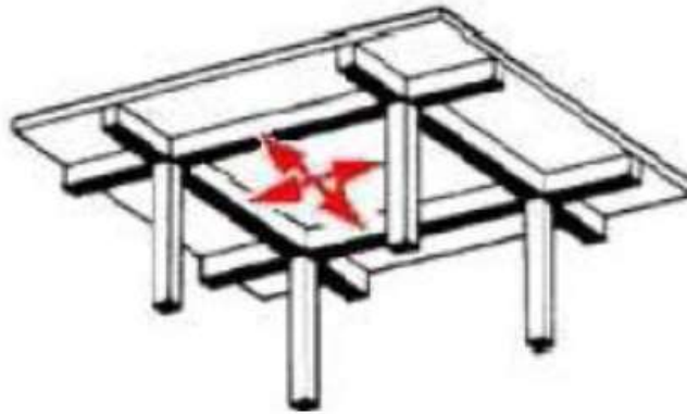
Figure III. 4 Dalle pleine sur 4 appuis
