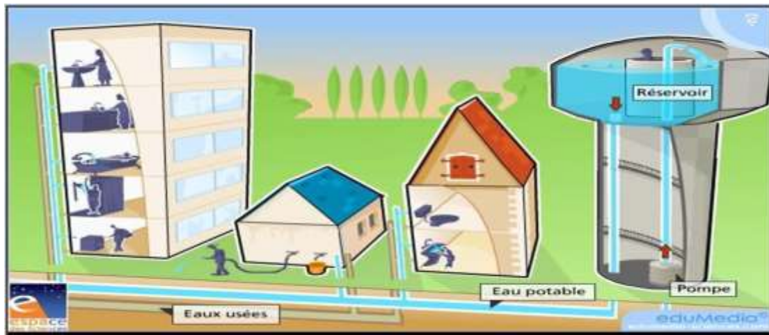
Figure I. 4 Schéma de fonctionnement d'un château d'eau [5]
