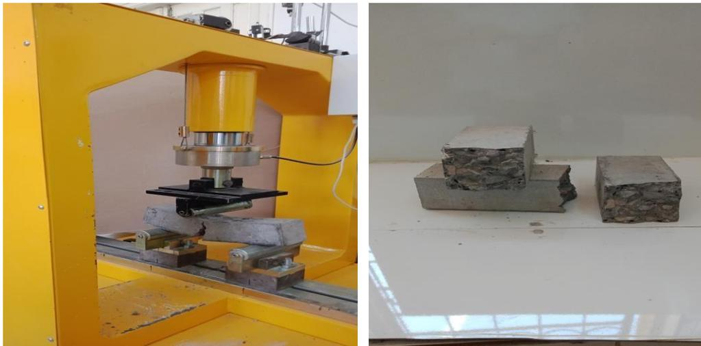
*Figure V.30: Essai de flexion*
