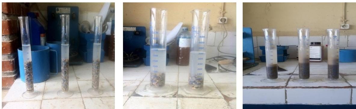
Figure I.7 : détermination de la masse volumique absolue[32].
