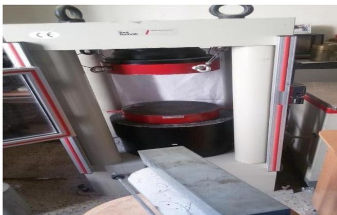
Figure IV.5: Machine d'essai de Traction par fendage[86].
