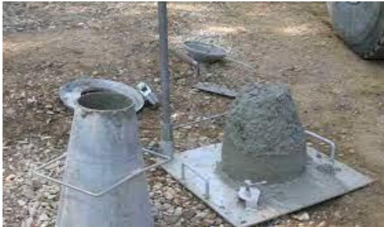
*Figure V.13:* essai d’affaissement
