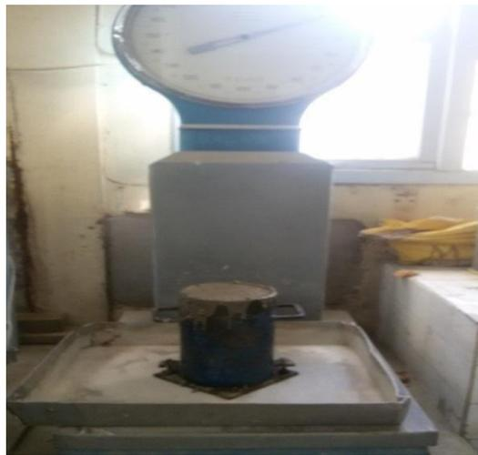
*Figure IV.2 : Mesure de la masse volumique à l'état frais [82].*
