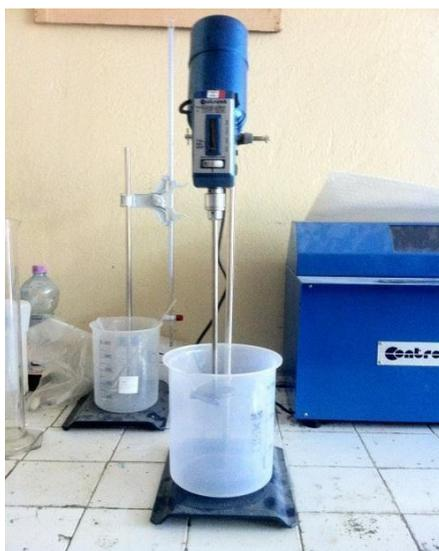
Figure I.9 : Appareil pour détermine la valeur de bleu méthylène [37].
