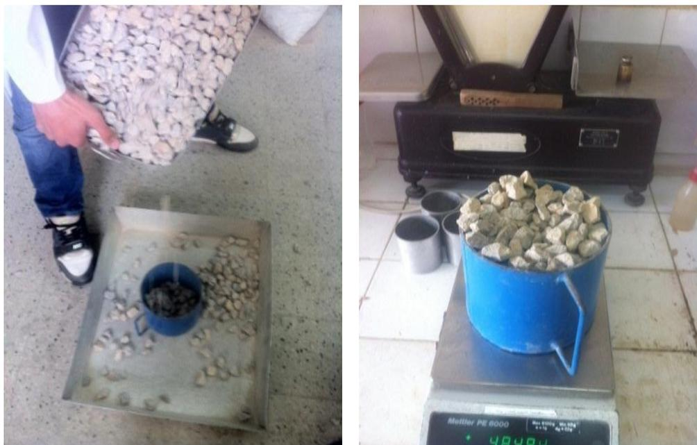
Figure I.6 : détermination de la masse volumique apparente[32].
