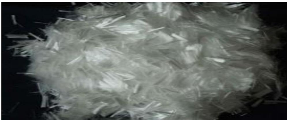
**Figure III.3 :** Les fibres de polypropylènes[73].
