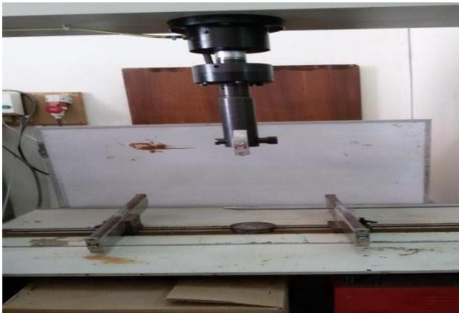
Figure IV.6: Machine d'essai de Traction par flexion[87].
