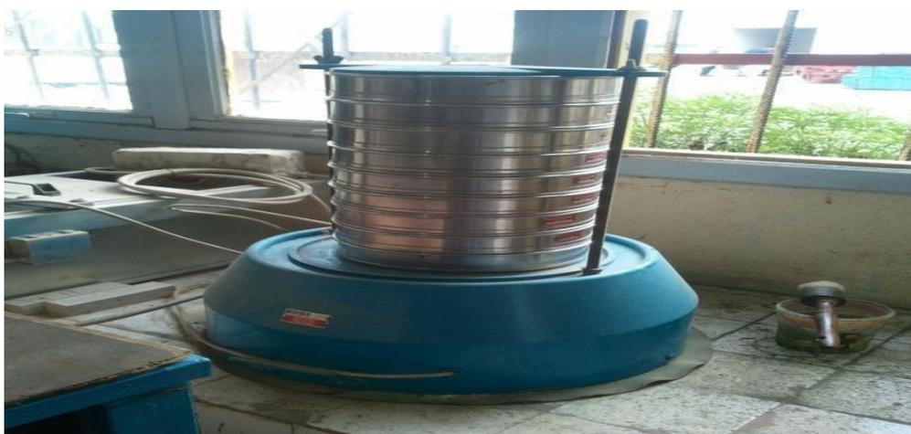
Figure I.3 : série des tamis pour la granulométrie [28].
