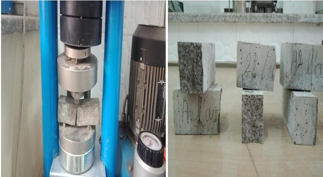
Figure V.10 : essai de traction
