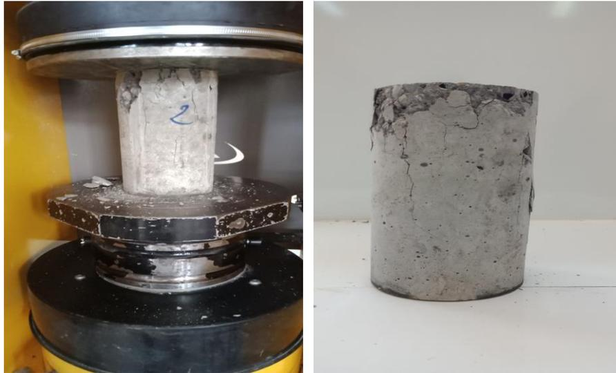
Figure V.18 : Essai de compression
