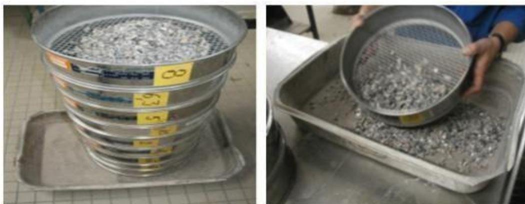
Figure I.4: L'analyse granulométrique par tamisage [28].
