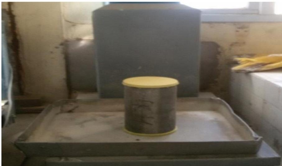
*Figure IV.7: Mesure de la masse volumique du béton durci [88].*
