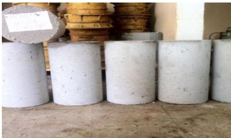
Figure IV.4: éprouvettes cylindriques de diamètre 16 cm et de hauteur 32cm [83].
