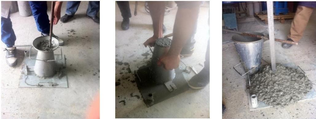
Figure IV.1 : Mesure d'affaissement au cône d'Abrams[81].
