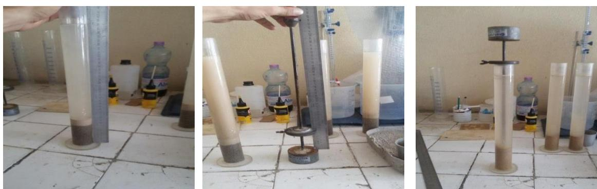
Figure I.8 : L'essai au piston de l'équivalent de sable [34].
