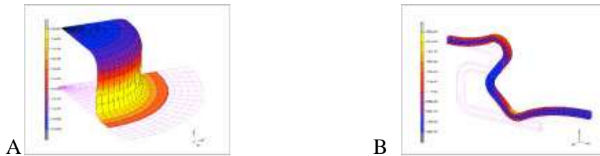
Figure II7 Exemples de non linéarité matérielle (A : Emboutissage de tôle. B : ARC Orthocentrique fait de nitinol en alliage à mémoire de forme). ( https://www.mscsoftware.com/fr/application/nonlinear-analysis ).
