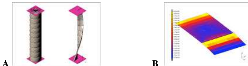
Figure II.6 Exemples de non linéarité géométrique, (A : Torsion d'une poutre. B : Flexion d'une plaque avec raidisseurs). ( https://www.mscsoftware.com/fr/application/nonlinear-analysis ).
