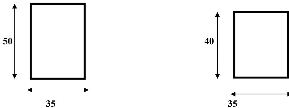
*Figure. II.1 : Dimensions des poutres principales*
