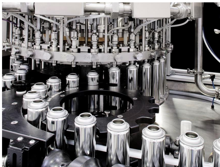
Figure II.1 : Vue d'une remplisseuse rotative.
