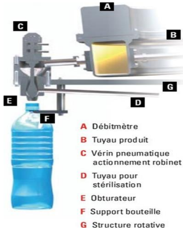
Figure II.4 : Constitution d'une remplisseuse à débitmètre. [20]
