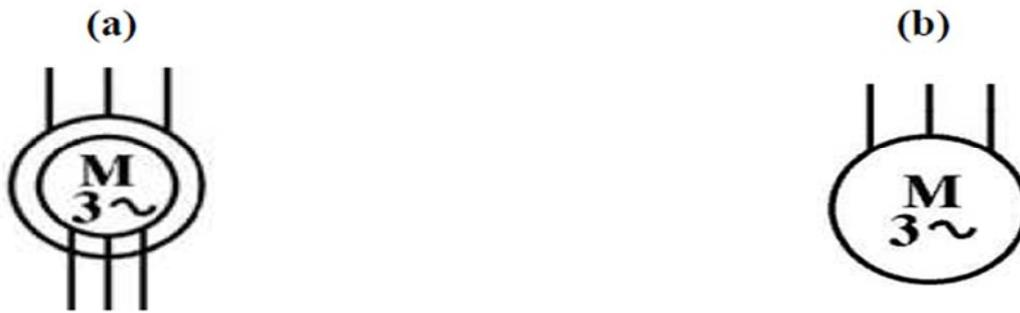
Figure 2.3 Symboles électrique du moteur asynchrone à rotor bobiné (a) et à cage d'écureuil (b)
