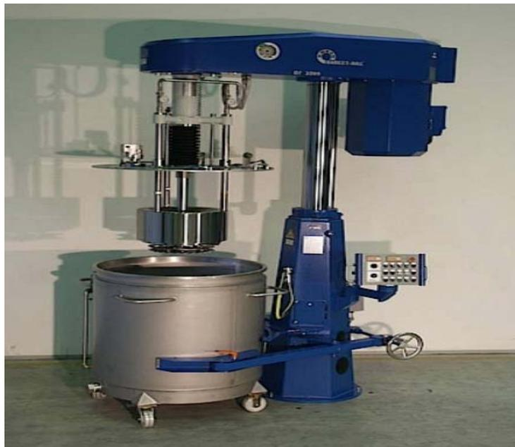
**Figure I.7** Vue générale du broyeur NIEMANN.
