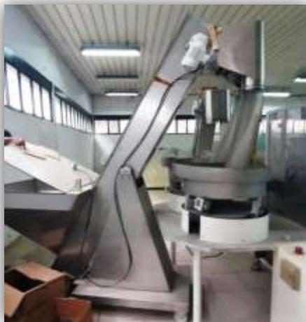
*Figure 1.3 : Bac et Elévateur.*
