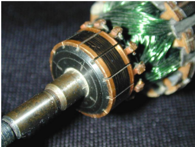
FIGURE 1.7 – Collecteur d’une machine à courant continu [31]
