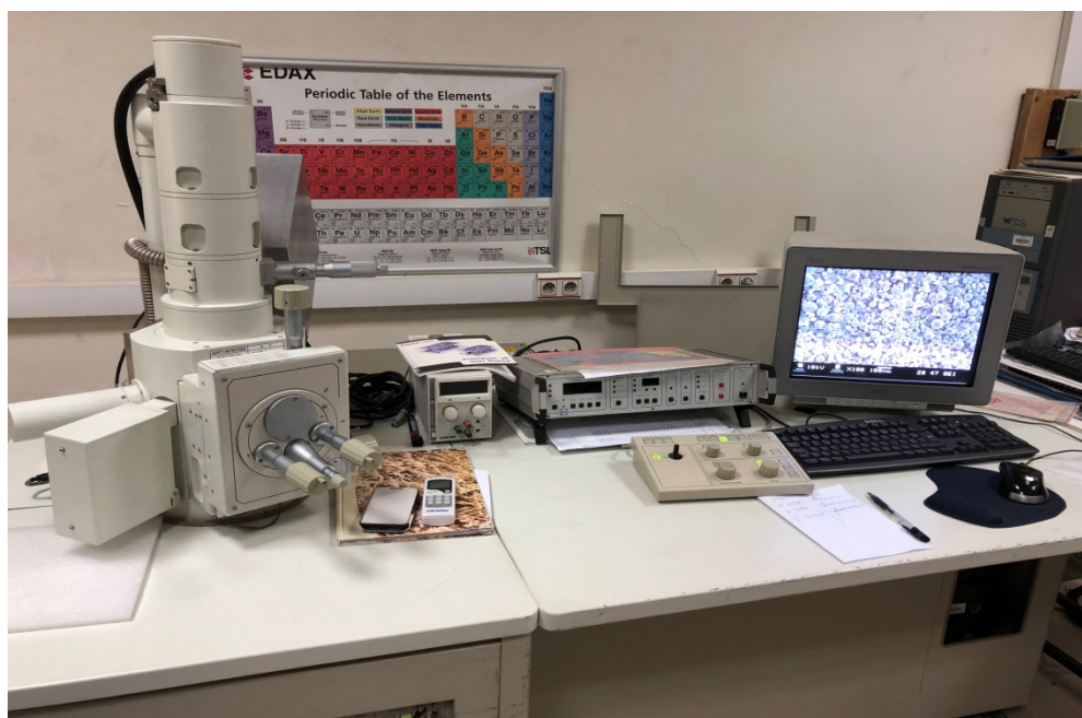
Figure 2.4 : Microscope électronique à balayage [de marque JEOL JSM-6360LV.CDTA d'Alger].
