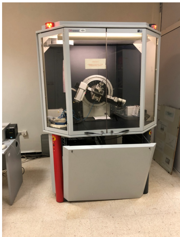
Figure 2.3 : Diffractomètre à rayon X de marque ADVANCE type D8.
