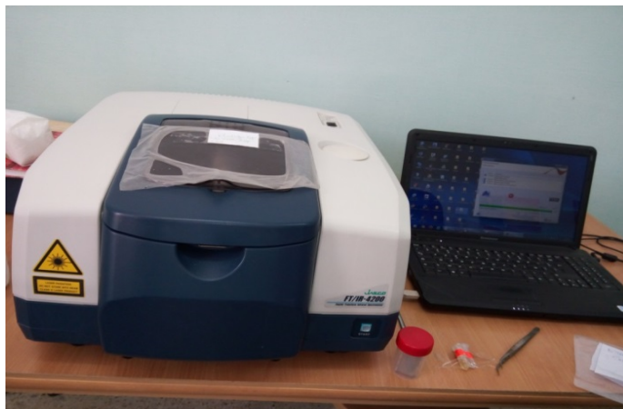
Figure 2.6 : La Spectroscopie Infrarouge à Transformée de Fourier (marque Jasco FT /IR-4200)
