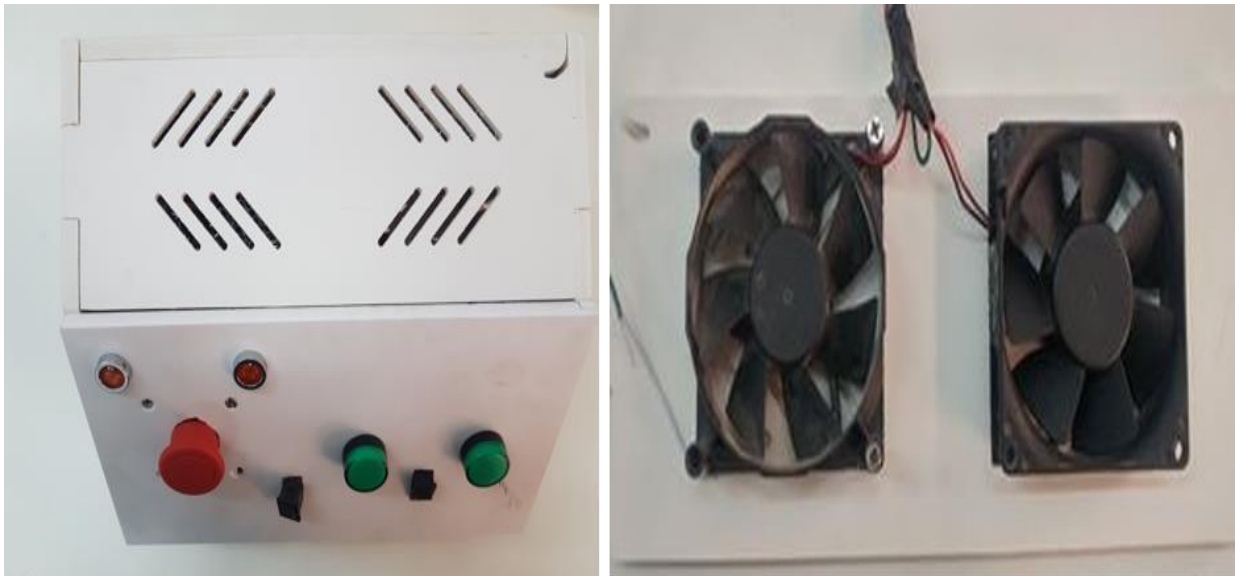
Figure 3. 32 : Deux ventilateurs d'aérations.
