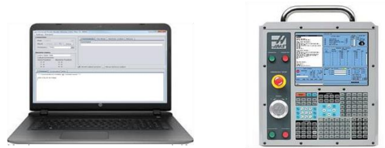
Figure 2. 13: Unité de commande par ordinateur et par pupitre de contrôle externe.
