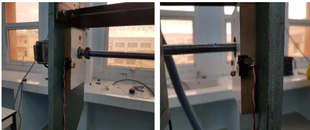
Figure 3. 21 : Les emplacements des fins de course axe-Y, Machine, droite et gauche.
