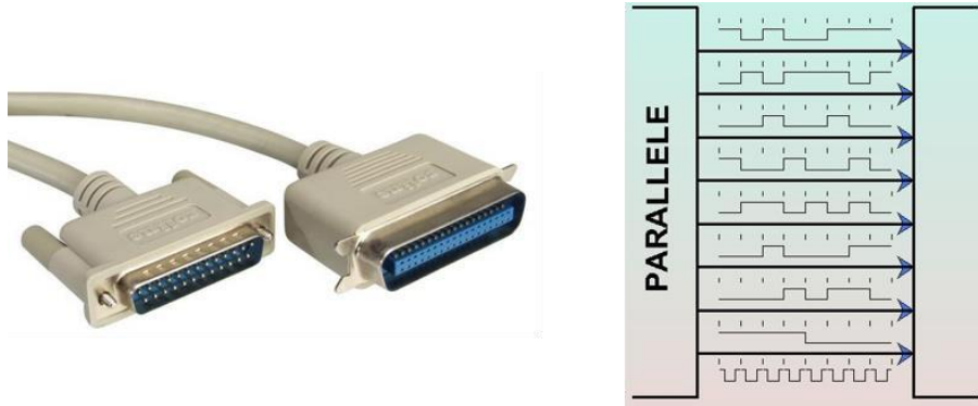
Figure 2. 15: Connecteur BD 25 et câblage d'une communication parallèle.
