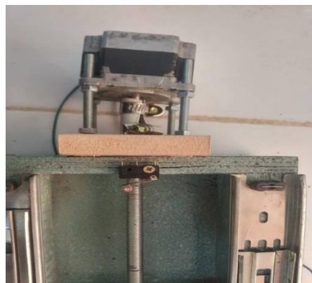
Figure 3. 22 : L'emplacements de fins de course, unique au chariot d'axe Y.
