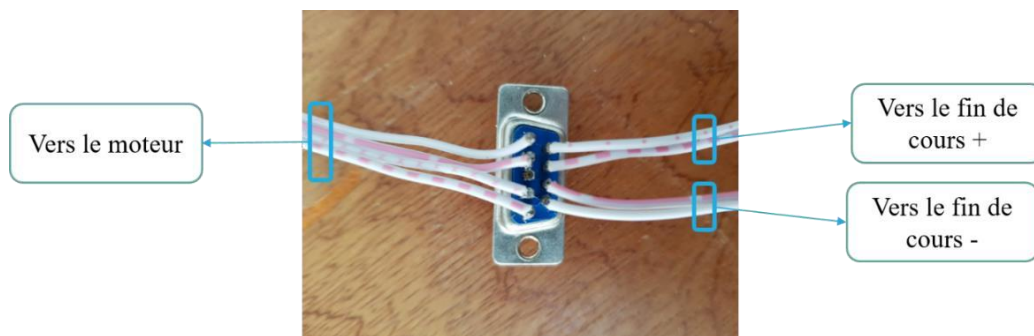
Figure 3. 27 : La disposition des pins de connexion des ports RS-232.
