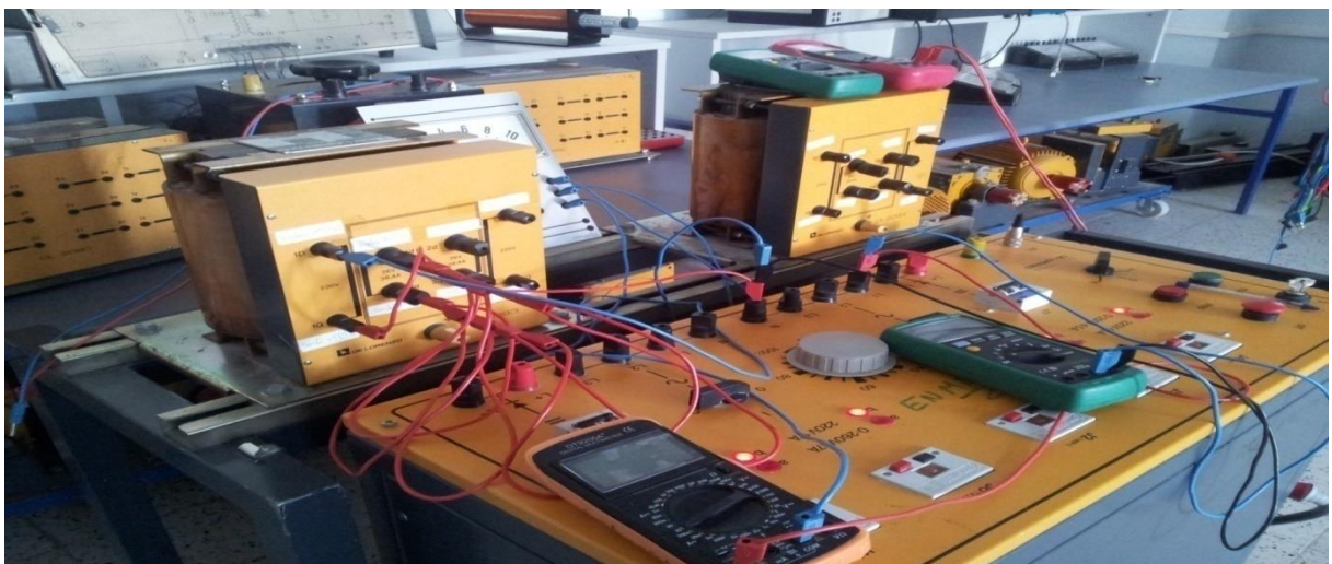
Figure III.5: Montage de l'essai en court-circuit d'un transformateur monophasé.
