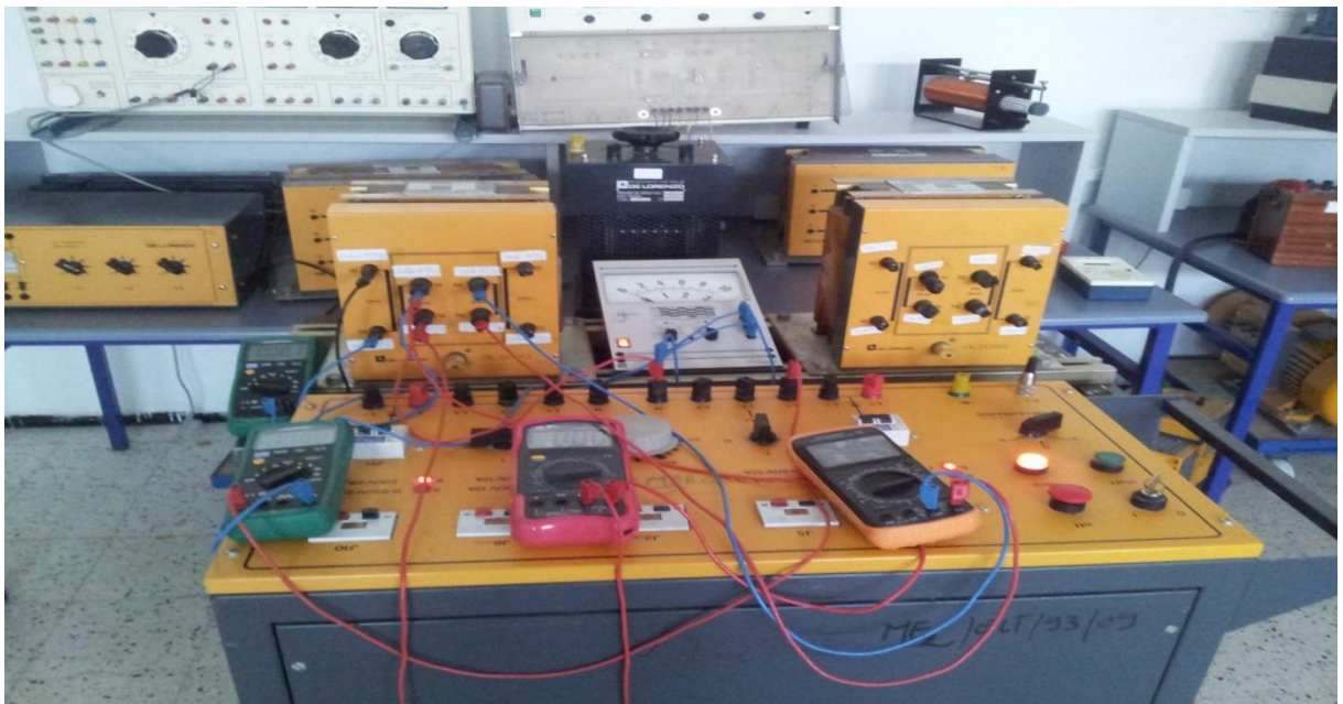
Figure III.4 Montage de l'essai à vide du transformateur monophasé.
