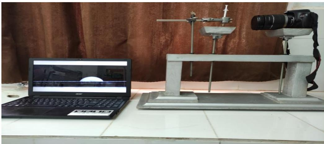
Figure 2. 11. Dispositif de mesure de l'angle de contact
