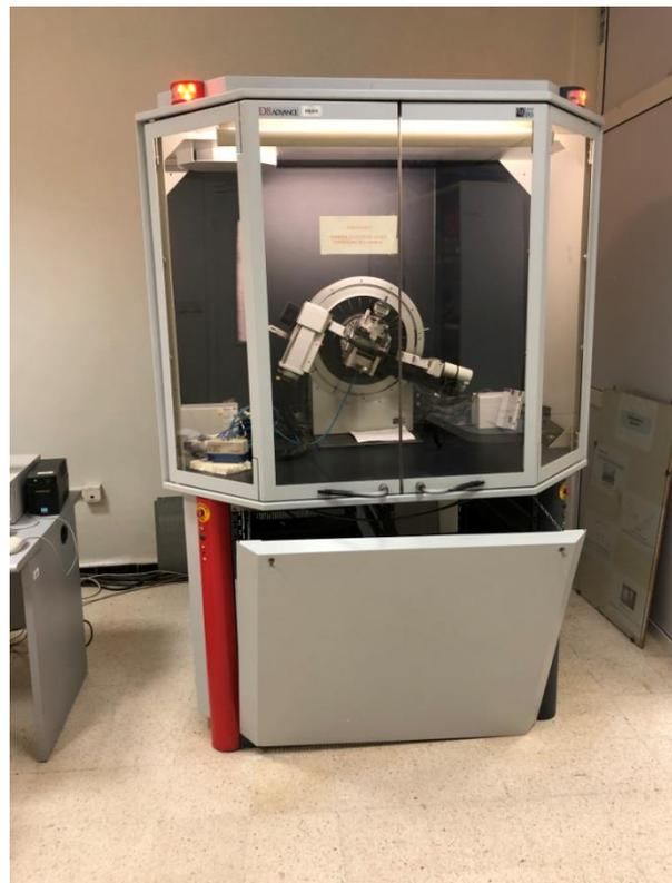
Figure 2. 16. . Diffractomètre à rayon X de marque ADVANCE type D8.
