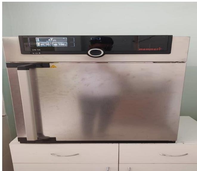
Figure 2. 8. Etuve (de marque Memmert UN55- 53L) utilisée pour le séchage
