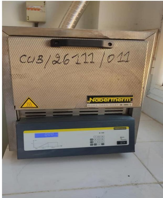
Figure 2. 9. Four à moufle de marque Nabertherm P330.
