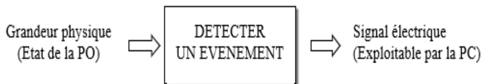
Figure 2.2: Schéma fonctionnel d'un capteur. [5]
