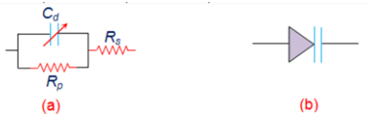
FIGURE 1.2 – (a) : circuit équivalent d'une diode varactor ; (b) : symbole diode varactor.
