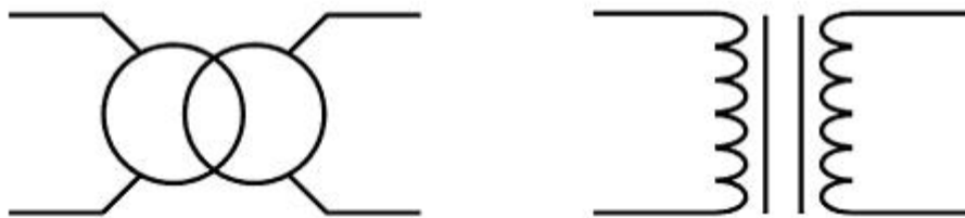
Figure.I.1 Symbole de transformateur monophasé[5].
