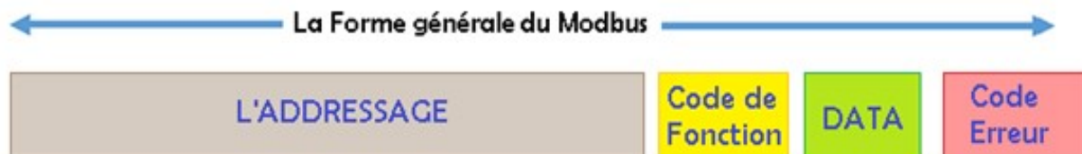
Figure II.5 : forme générale du MODBUS
