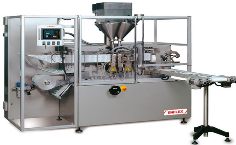
Fig. II.1 : Machine de conditionnement Enflex F11. [21]
