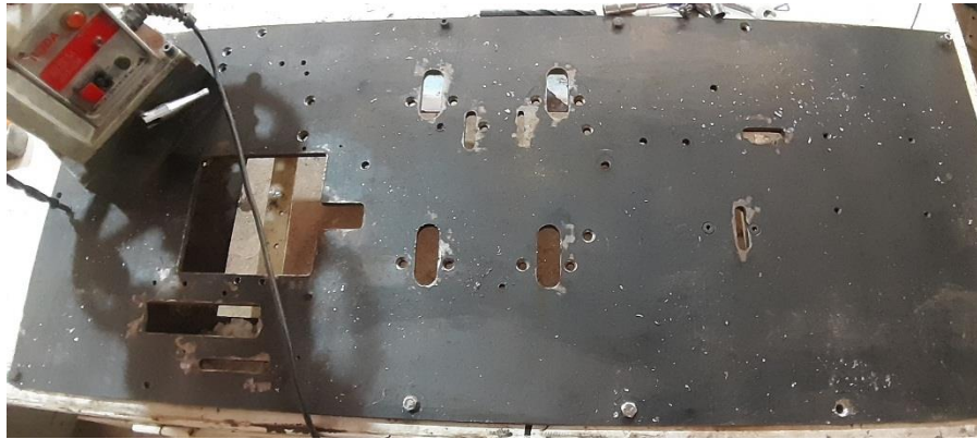
Fig. III.14 : Découpe CNC de la tôle.
