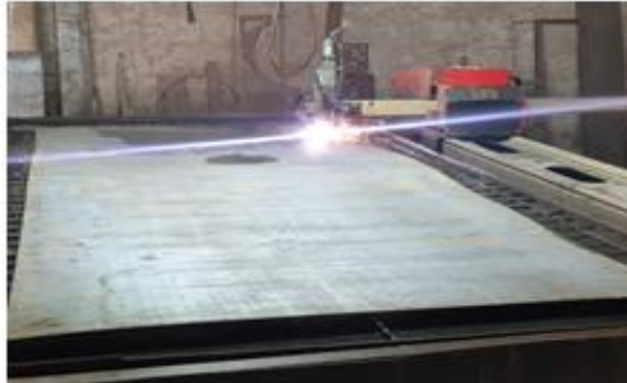
Fig. III.14 : Découpe CNC de la tôle.
