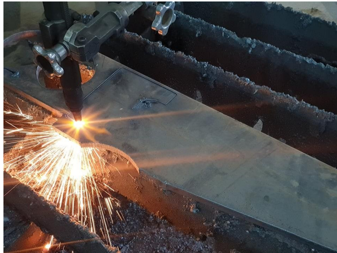
Fig. III.12 : Oxycoupage des paliers et des cames.
