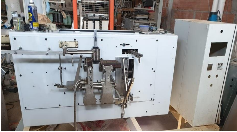
Fig. III.16 : Mâchoire de soudage et couteau assemblés.
