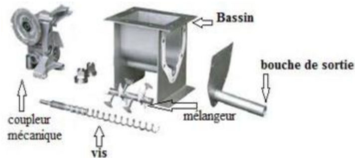
Fig. II.38 : Vue éclatée d'un doseur à vis.
