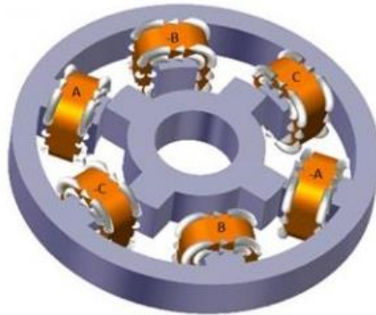
Figure (III.7) : la construction du moteur pas à pas [24].
