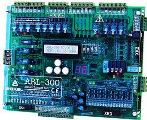
Figure (I.16) : commande d'un ascenseur par microcontrôleur.
