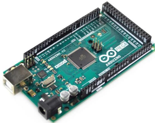
Figure (II.1) : La carte Arduino Méga 2560 [18].
