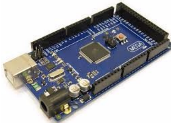
Figure 2.5 : Carte Arduino mega. [34]
