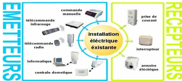
Figure 1.6 : Présentation de la technologie du courant porteur en ligne. [15]
