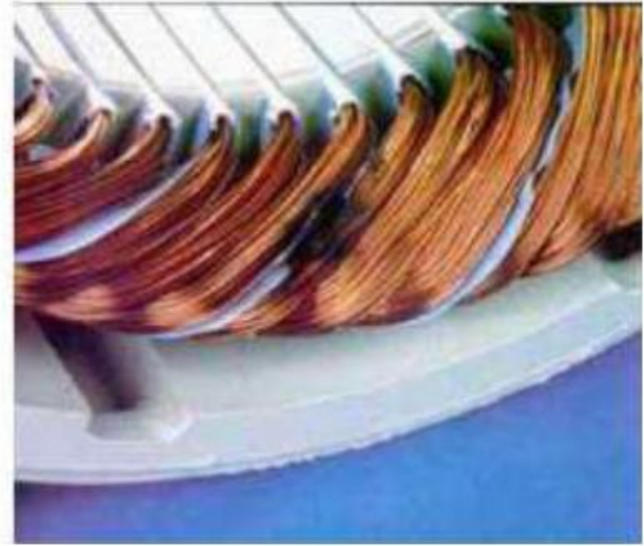
(a) Ouverture d'une phase (b) court-circuit dans une phase
