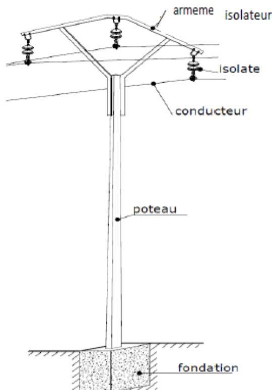
FIGURE 2.2 – Composantes d'une ligne électrique
