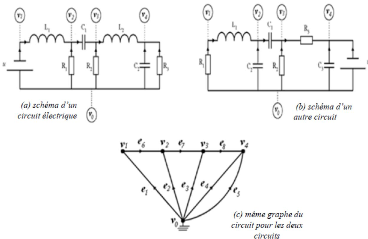
FIGURE 3.10 – Circuits différents avec même graphe
