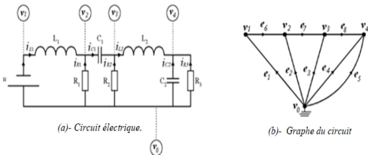
FIGURE 3.8 – Circuit électrique et son graphe
