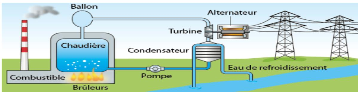
FIGURE 2.3 – Centrale thermique à flamme
