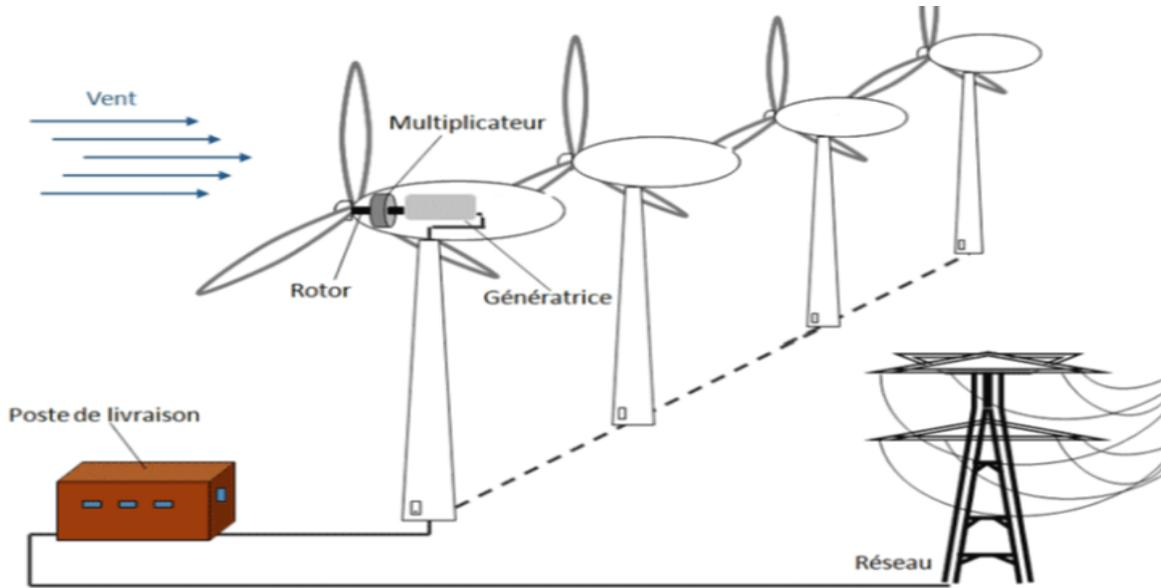
FIGURE 2.7 – Schéma de principe d'une production éolienne
