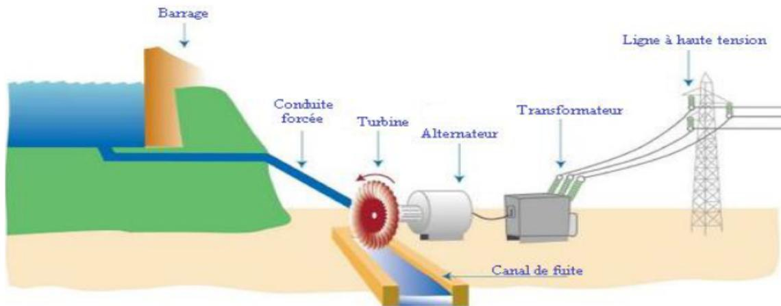
FIGURE 2.5 – Centrale hydroélectrique
