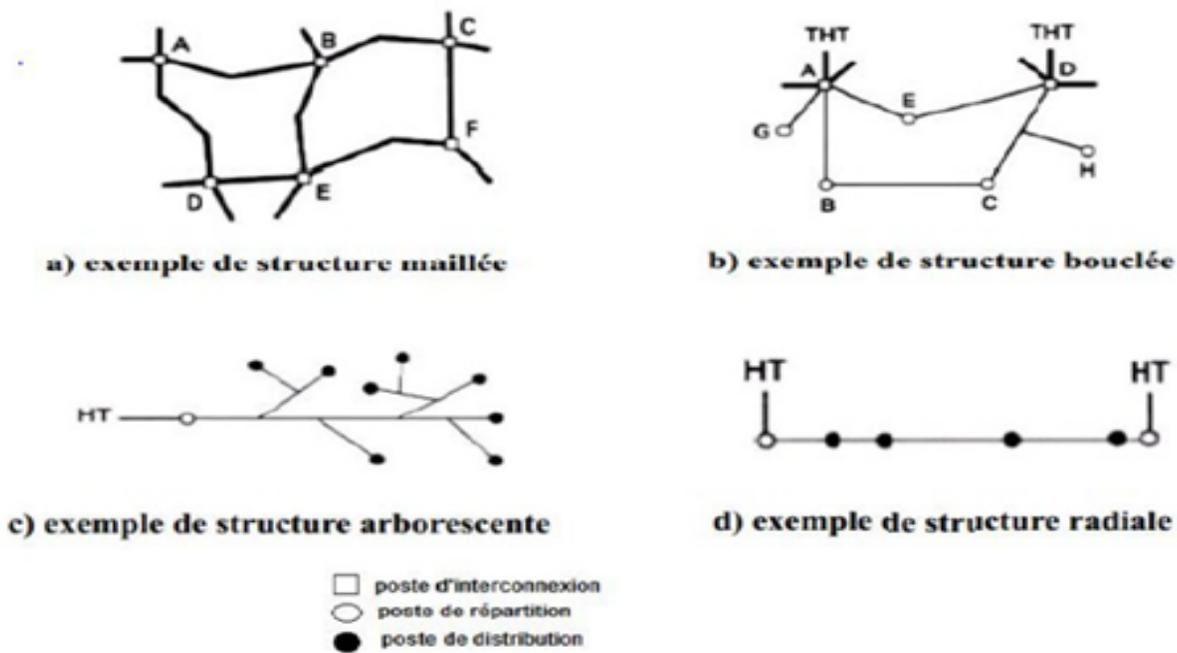
FIGURE 2.8 – Topologie des réseaux électriques
