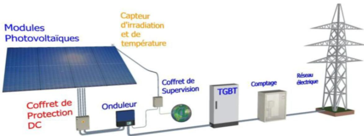
FIGURE 2.6 – Schéma de principe d'un générateur photovoltaïque
