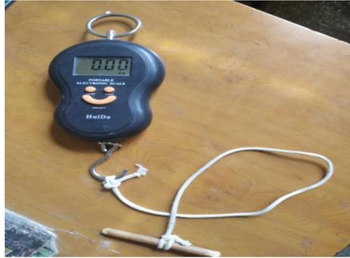
**Figure N°12 :** La pesée avec un mini balance digitale (photo personnelle).
