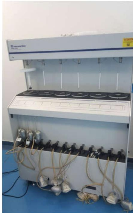
**Figure 10** : l'instrument utilisé pour l'analyse par méthode BET.
