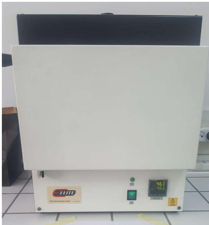
**Figure 8** : le four utilisé pour la calcination des échantillons.
