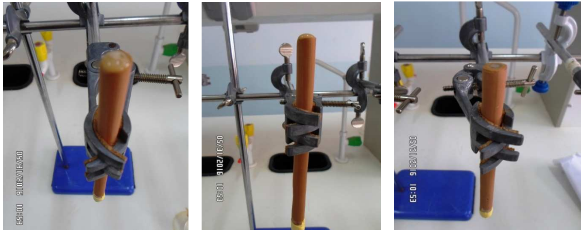
Figure (III-18) : Images représentatives des tubes bouchés, remplis de barbotine en position verticale
