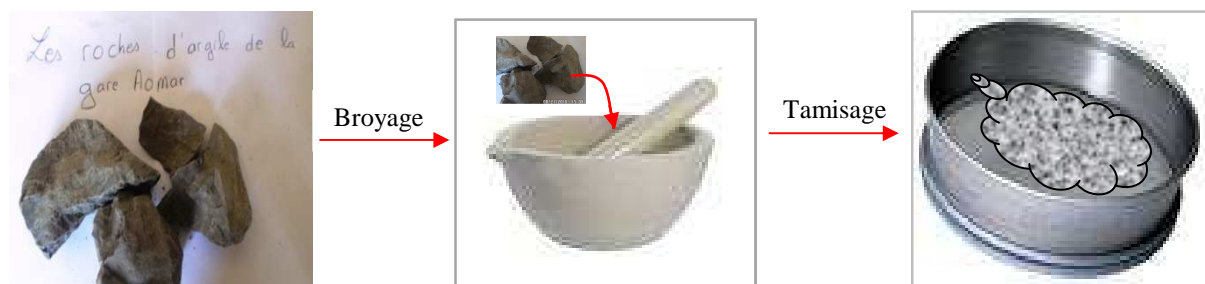
Figure (III-1) : figure représentative des étapes d'obtention d'une poudre de l'argile d'Aomar brute
