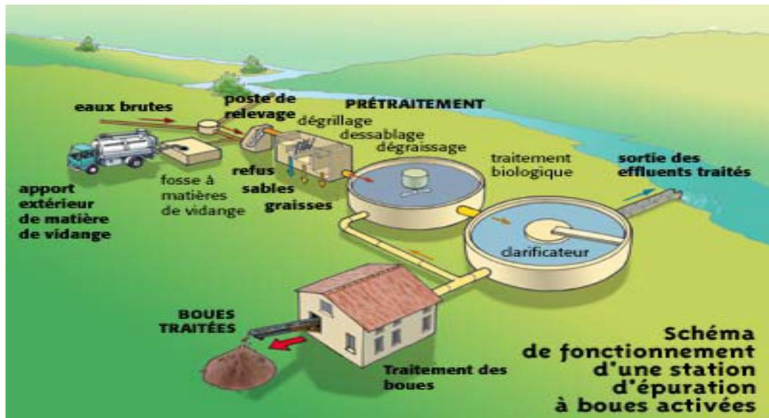
Figure I.1 : Station d'épuration à boues activées
