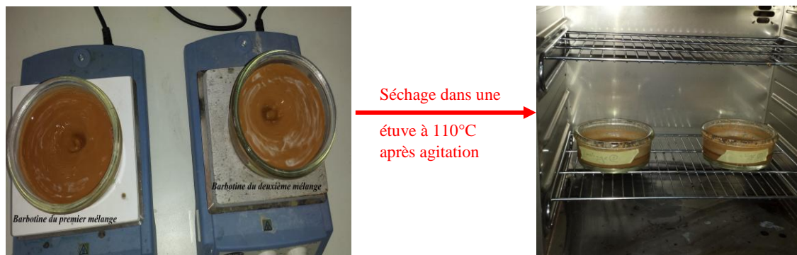
Figure (III-7) : Etapes représentatives des barbotines préparées et destinées à la fabrication de carreaux de faïence
