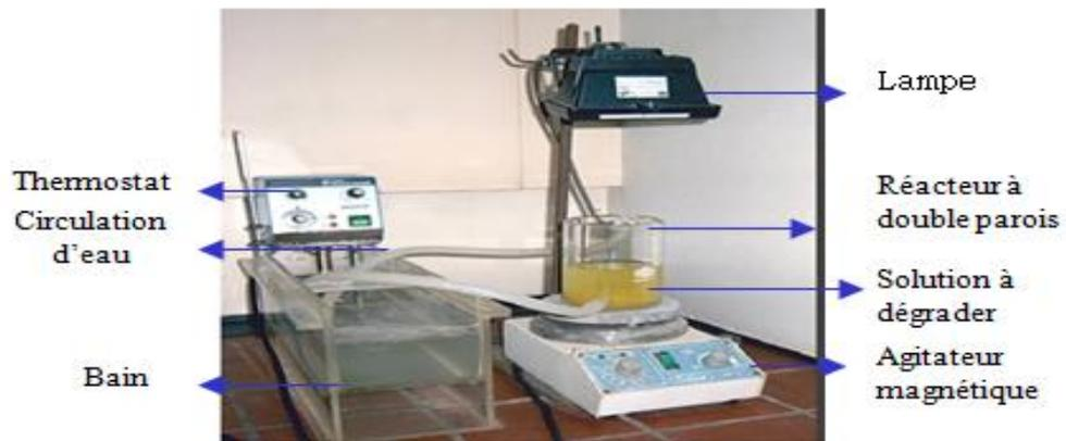
**Figure II-5 :** *Dispositif expérimental de la photodégradation sous la lampe*
