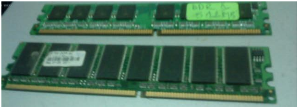
Figure 29: Généralement les RAM n'ont pas de symptôme visible de l'extérieur, à part celui du connecteur qui est déformé
