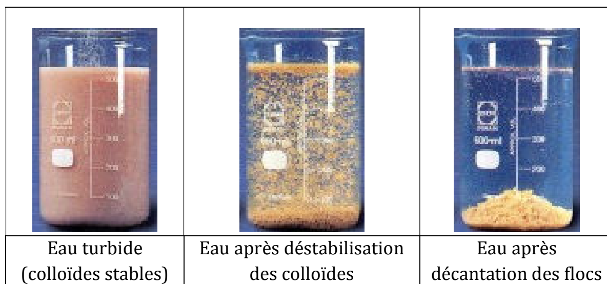
Figure 3-1 : Principe de la floculation.
