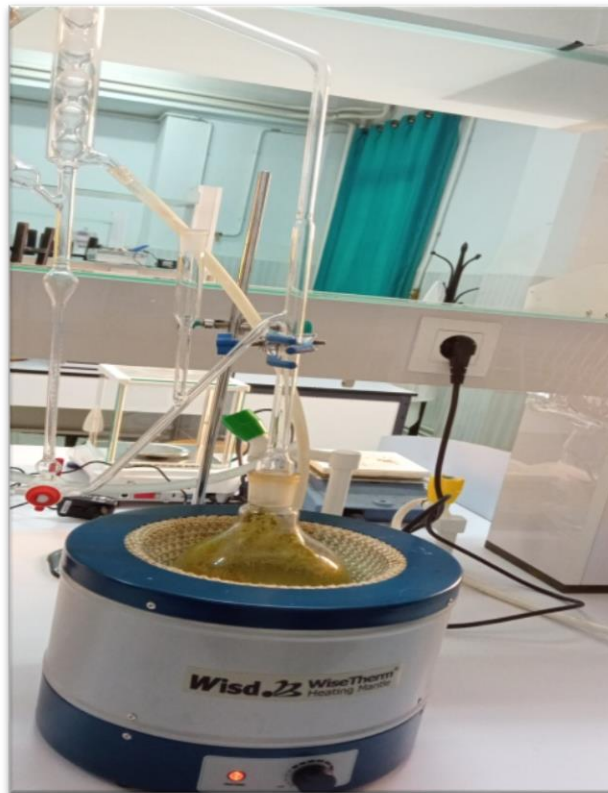
Figure 10 : Extraction des huiles essentielles par hydrodistillation
