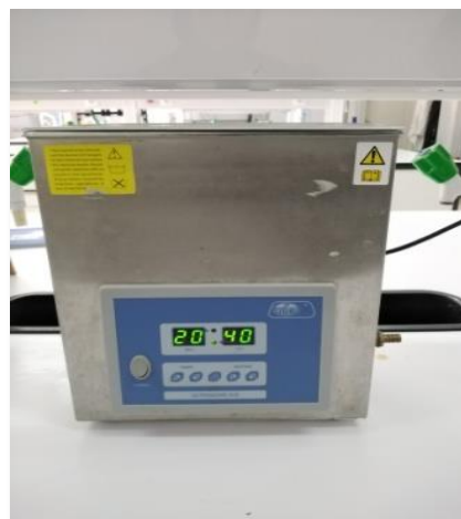
Figure 12 : Extraction dans un bain à Ultrasons
